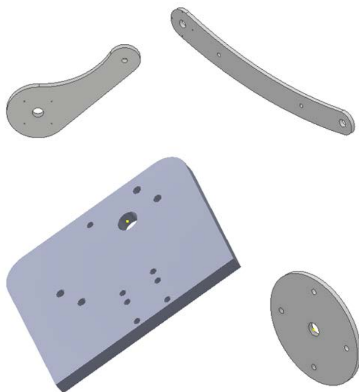
2.3 – сурет – AutoDesk Inventor Pro бағдарламасында сызылған роботтың детальдары
