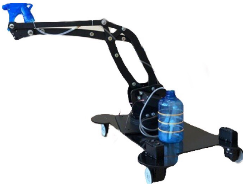
3.2 – сурет - Бүріккіш құрылғысымен жабдықталған uArm роботы
